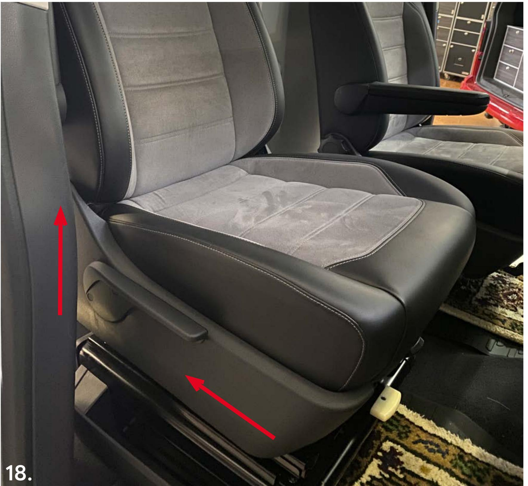
Um den Sitz zu drehen, fahren Sie diesen ganz nach hinten und etwas nach oben, sonst bleibt die Plastik-Verkleidung hängen (Bild 18).
