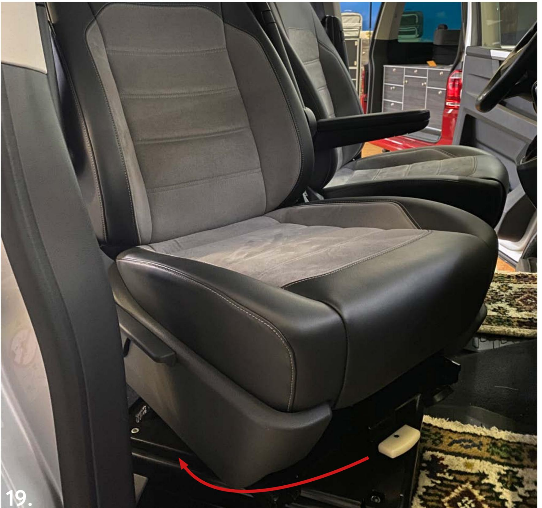
Ziehen Sie den Eisen-Hebel nach oben und drehen Sie den Sitz im Uhrzeigersinn. Achten Sie auf den Becherhalter und die Sonnenblende, falls diese ausgefahren bzw. ausgeklappt sind (Bild 19).
