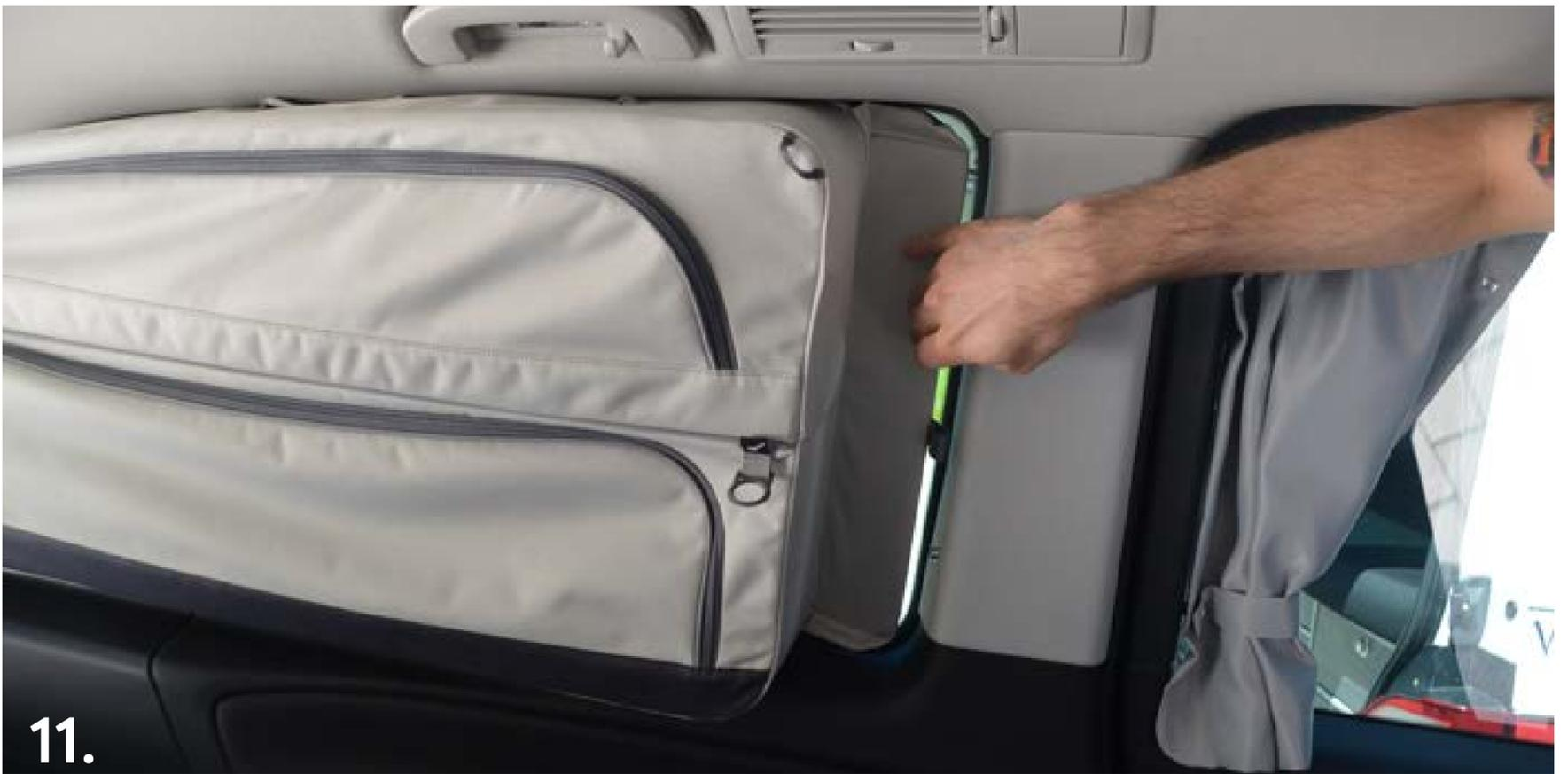
Klappen Sie nun die Lasche nach hinten ans Fenster und drücken diese so an, dass sie hinter der Gummilippe Halt findet (Bild 11).
