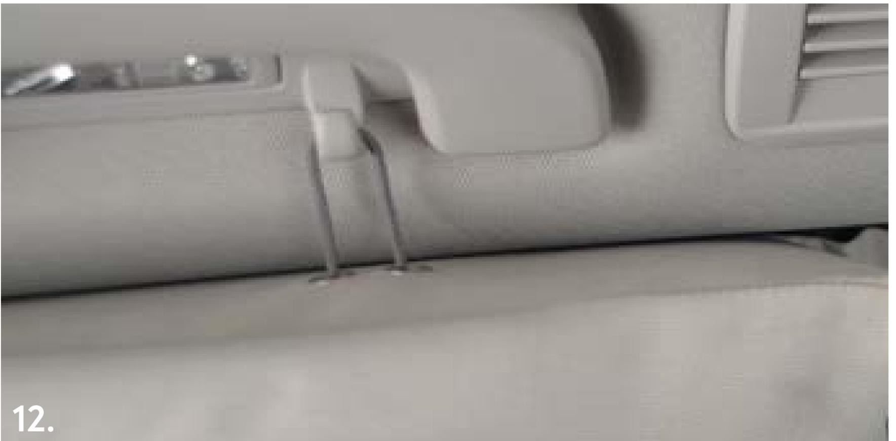
Bei Bedarf kann zusätzlich die Schnur am Häkchen des Haltegriffs eingehängt werden. Öffnen Sie ggf. den Reißverschluss des oberen Faches und drücken die Tasche leicht nach oben (Bild 12).
