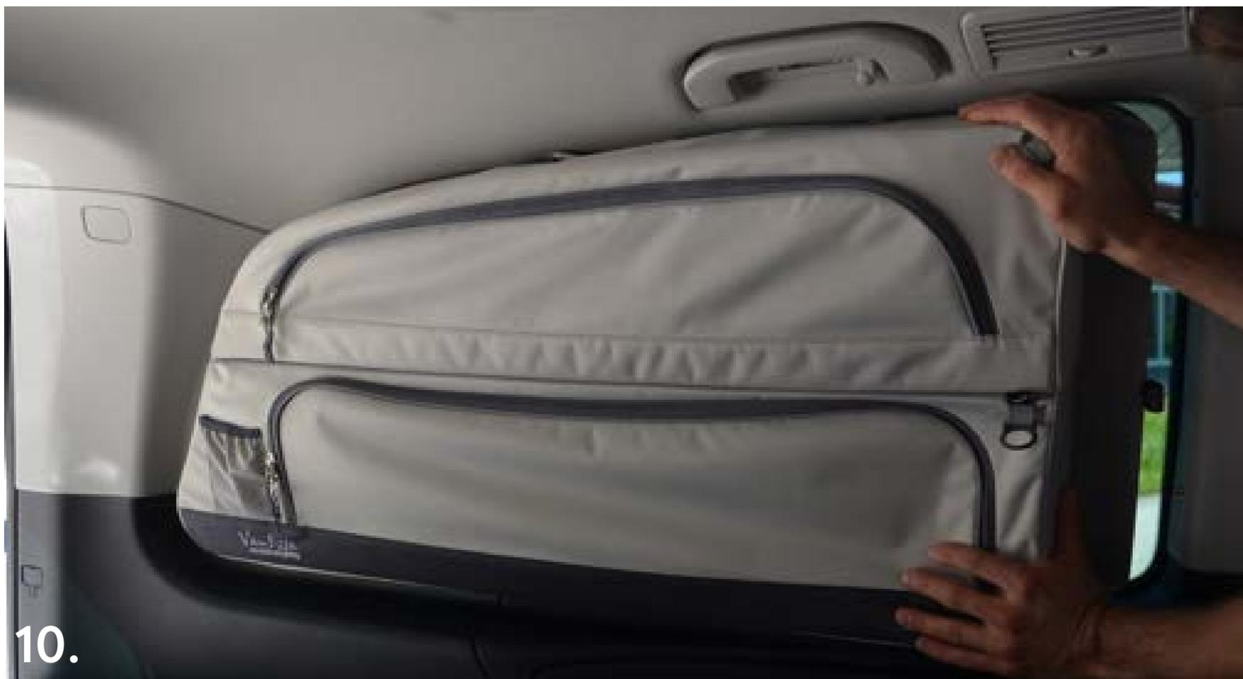
Klappen Sie die seitliche Lasche ein und setzen Sie die Tasche vorne (im Fahrzeuginneren) bündig an. Die Rückplatte der Tasche wird erst oben, dann unten am Fensterrand hinter die Gummilippe eingefädelt.
