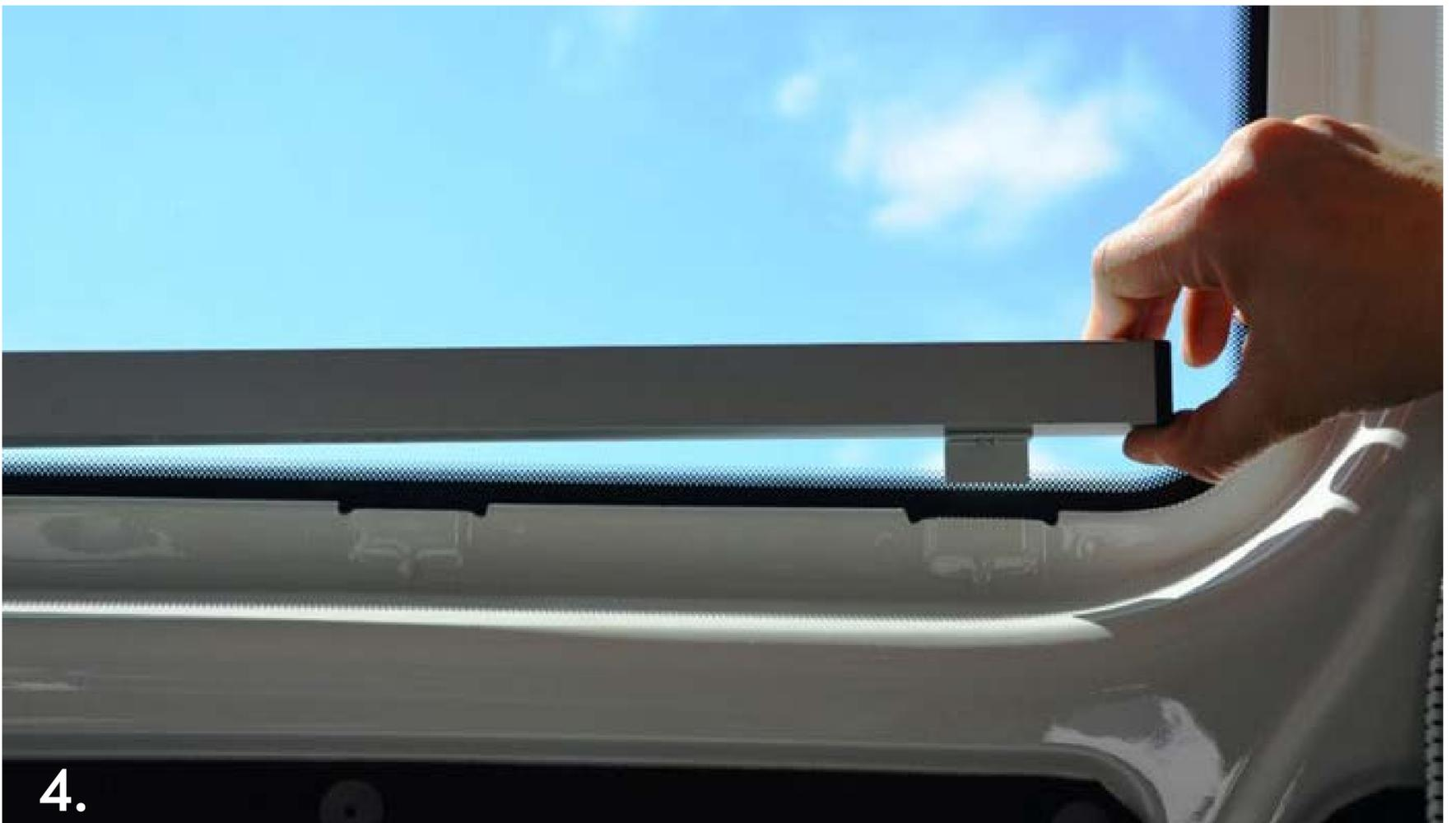
Stecken sie die Leisten mit zwei Winkel unten in die Ösen der Blechverkleidung (Bild 4).
