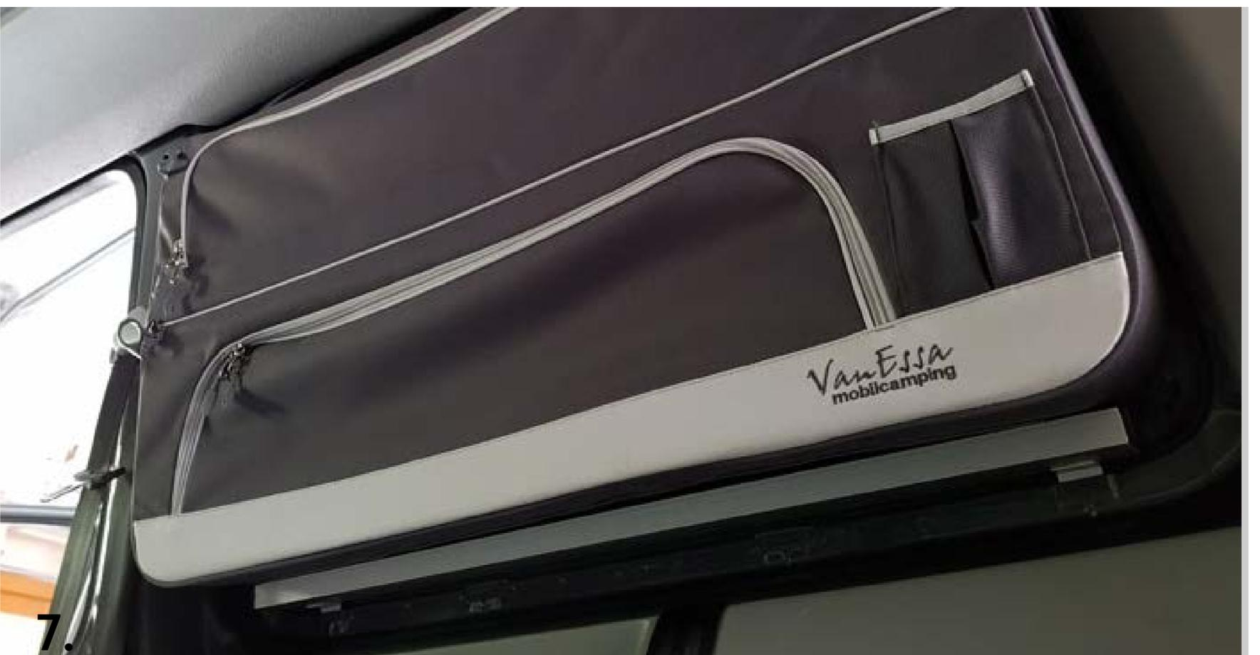
Fädeln Sie die Rückwand der Packtaschen oben hinter die Winkel (Bild 6) und schieben Sie die Taschen unten auf die Alu-Leiste bis die Tasche ganz am Fenster anliegt (Bild 7).
