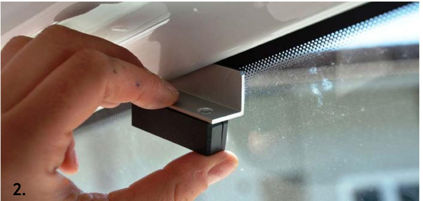
Stecken Sie die mitgelieferten Z-Winkel vorne und hinten zwischen Verkleidung und Fenster (Bild 2).
